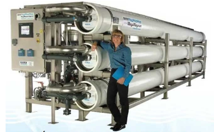
Hệ thống màng lọc sinh học MBR KOCH xử lý nước thải để tái sử dụng
